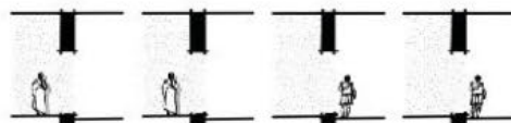
passage d'1 pers. passage de 2 pers. passage de 4 à 5 pers. objets encombrants
