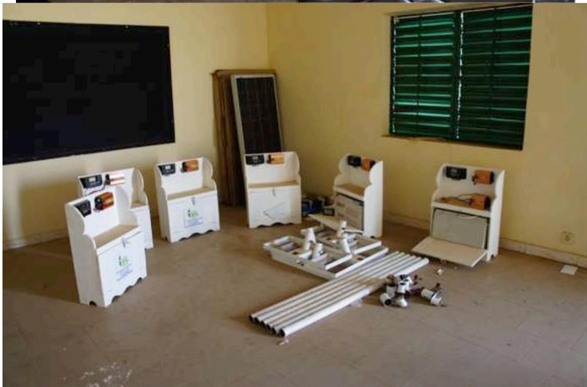
Cuisinières solaires, kits solaires individuels (en construction puis avec batterie et onduleur), réverbères démontés dans le centre de formation de Méckhé, avril 2019
