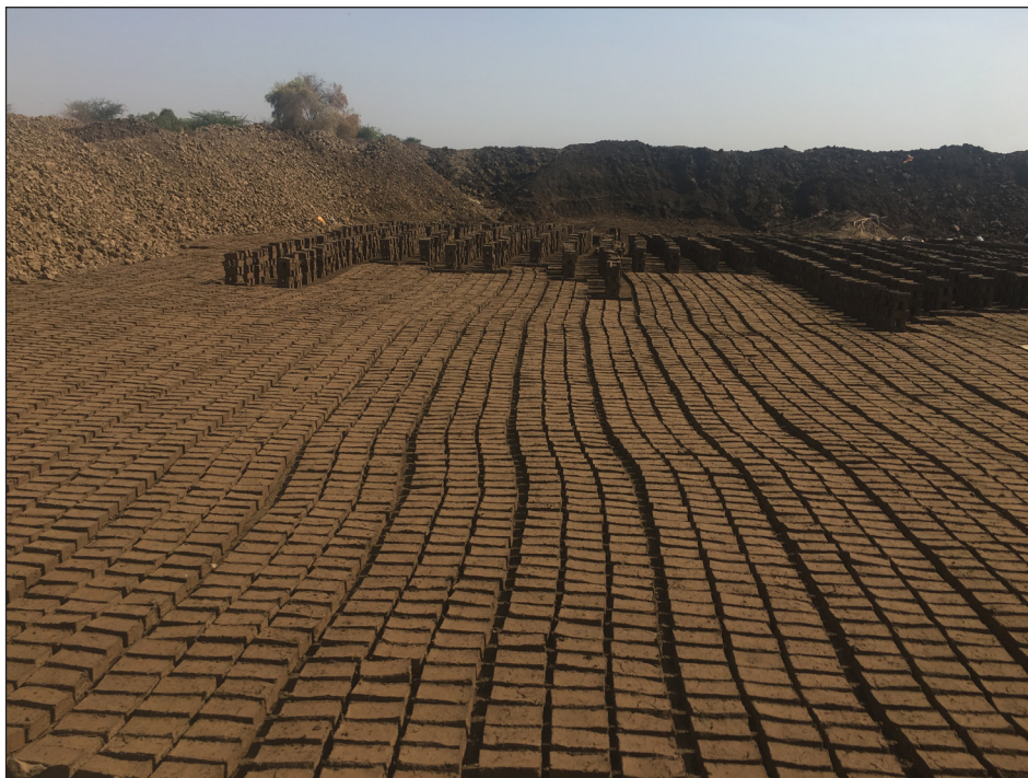
Figure 4 : Les briques sèchent au soleil pendant un jour ou deux
