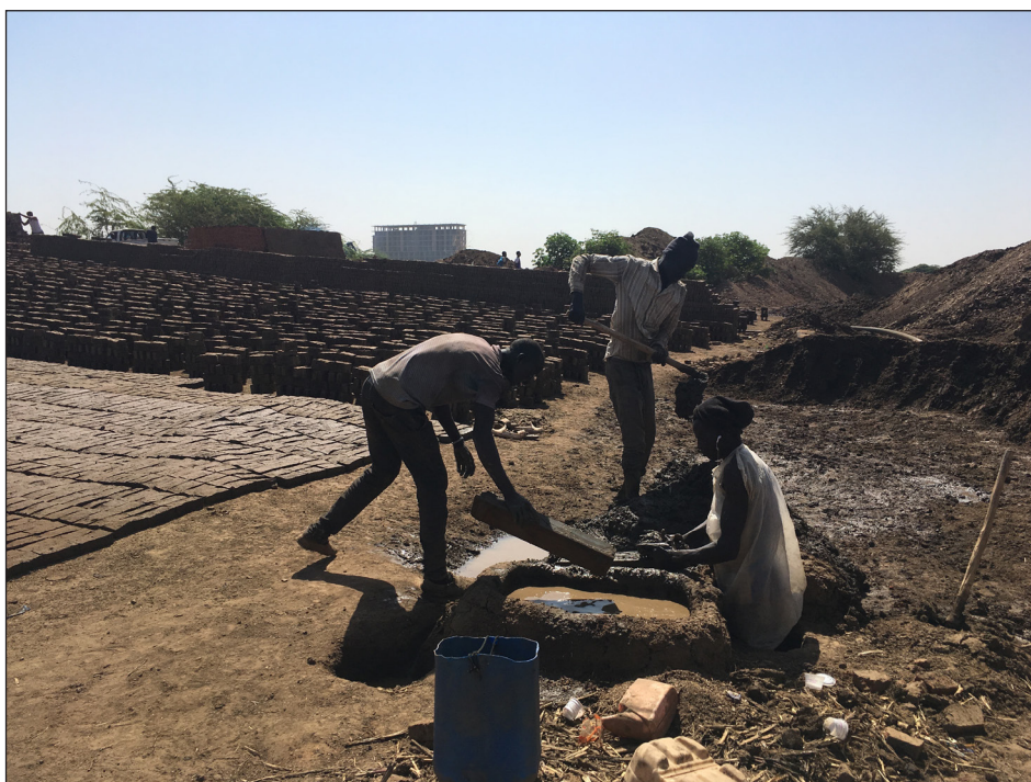
Figure 3 : Ouvriers qui moulent des briques à partir du mélange de limon, d'eau et de fumier animal
