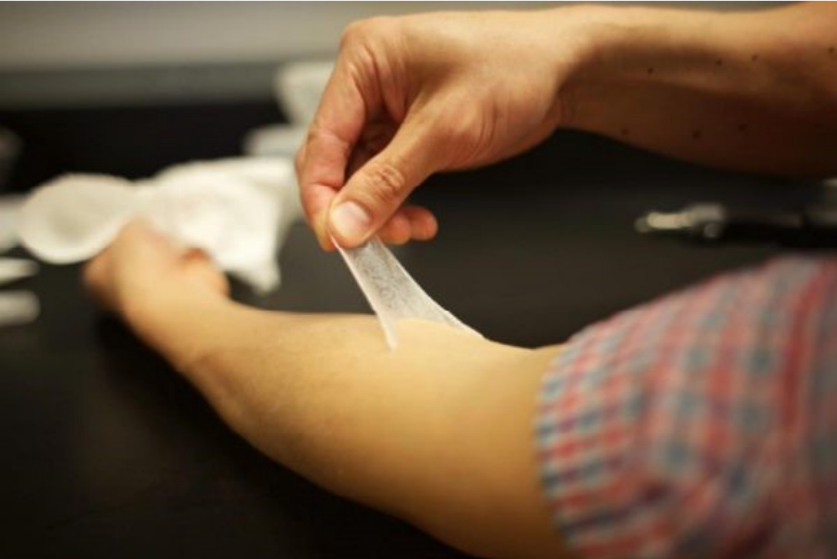
« Engineering a second skin ». Peau artificielle composée d'une fine couche de polymère © MIT 2016.
