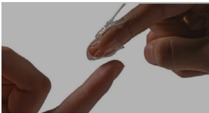
Prototype composé de silicone extensible, de capteurs, d’électrodes et d’« actionneurs pneumatiques souples » (SPA). École Polytechnique de Lausanne, 2019, © EPLF.
