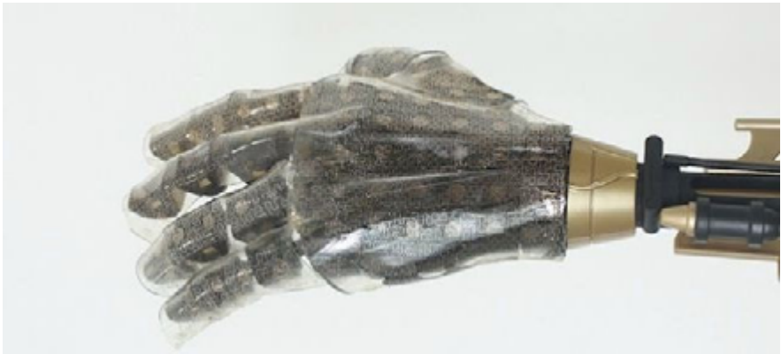
Gant transparent électronique en film polymère, nanofils en or et silicium, 2014.
