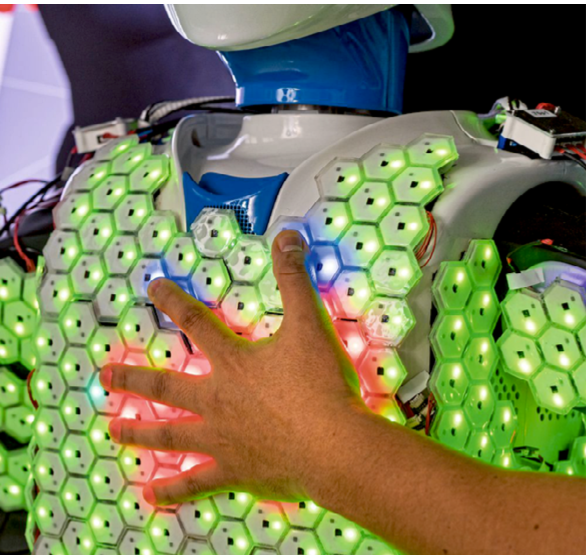
Cellules hexagonales de mécanorécepteurs sur le torse d'un robot, Université Technique de Munich © Ça m'intéresse , 2019.
