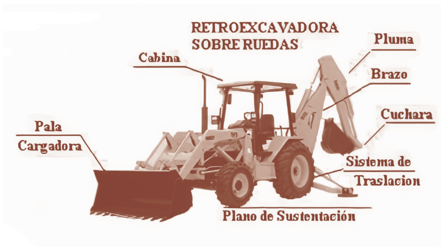
Figura 2. Esquema de las partes de una retroexcavadora
