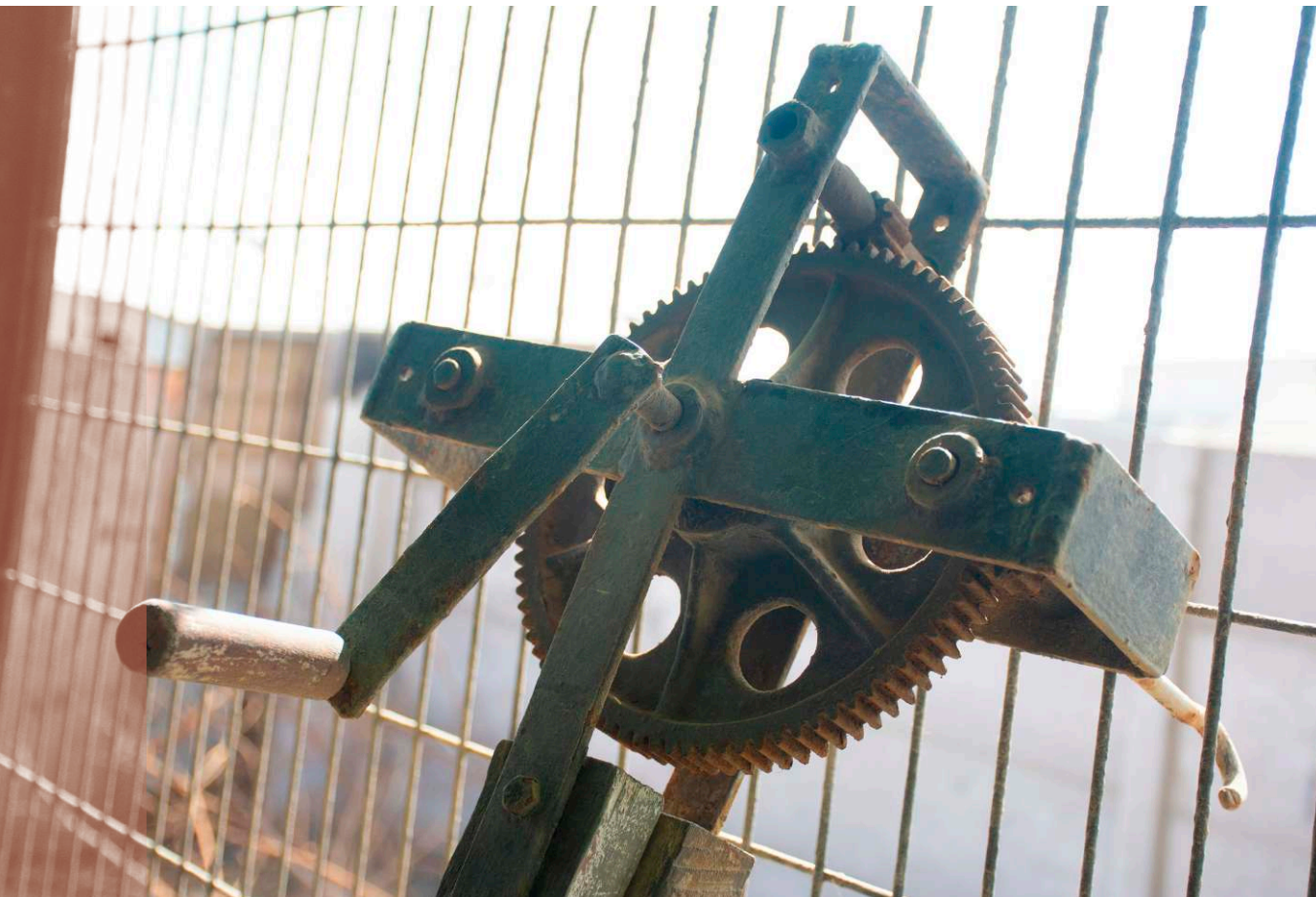
Figura 3. El rolete permite obtener cordeles o cabos de diferentes grosores
