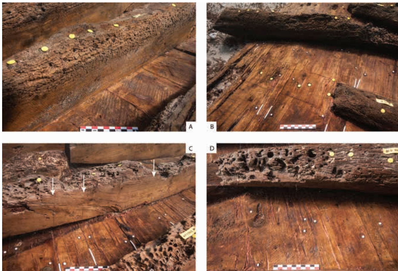
Sl. 35 a) Tragovi pile vidljivi na oplati i brodskom rebru; b) dvije paralelne linije urezane oštrim predmetom koje označavaju položaj brodskog rebra F05N; c) X oznaka između F10S1 i F09S1; d) Okomite linije ispisane ugljenom na zapadnoj strani rebra F10N: linije se nalaze na spojevima vojeva (fotografija: L. Damelet).
