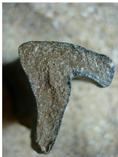
Fig. 6 - Liseré noir dans la section d'un fragment de grès
