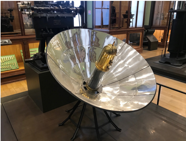
Fig. 2 : four solaire d'Augustin Mouchot et Abel Pifre, vers 1880, modèle au 1/3, Musée des Arts et Métiers. Paris. (Cl. F. Caille)
