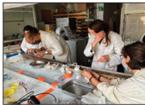
F. Échantillonnage d'une carotte
