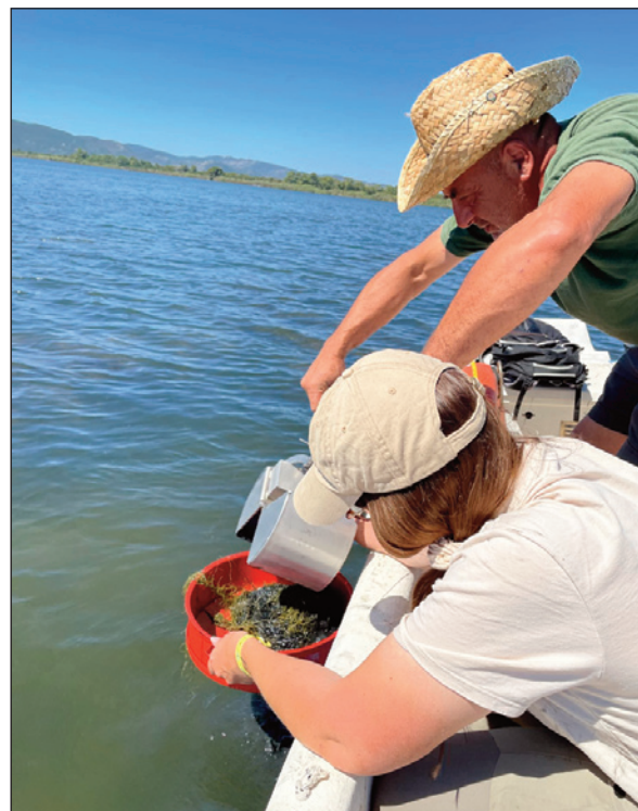
8. PRÉLÈVEMENT DE LA MALACOFAUNE BENTHIQUE ACTUELLE À L'AIDE D'UNE BENNE VAN VEEN ET D'UN TAMIS (1 MM) DANS LA LAGUNE D'ORBETELLO (cliché A. Bertini)
