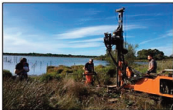
A. Carottier terrestre rotatif
