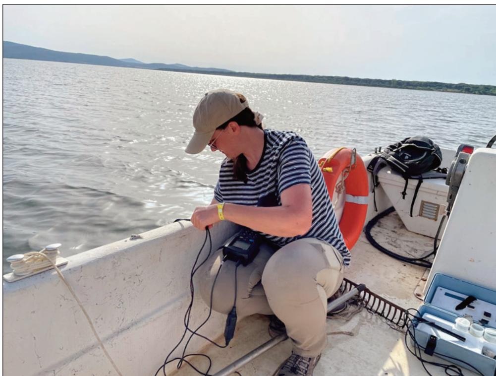
10. MESURES DES CARACTÉRISTIQUES PHYSICO-CHIMIQUES DES EAUX LAGUNAIRES DE LA LAGUNE D'ORBETELLO À L'AIDE D'UNE SONDE MULTIPARAMÈTRES (photo A. Bertini)
