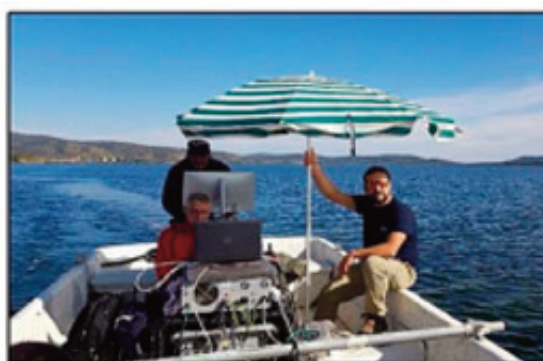
D. Profils acoustiques dans la lagune
