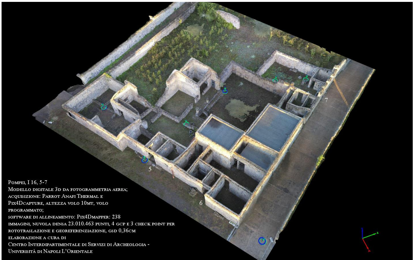
Fig. 28. Modello digitale 3D, da fotogrammetria aerea, del settore meridionale dell'insula I 16 (R. Valentini).
