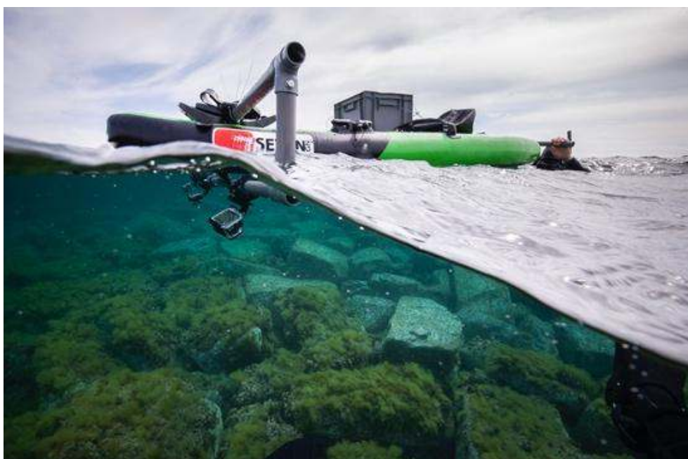
Fig. 8 : Vue du Photograboat, propulsé par un opérateur, au cours d'une série de prises de vues
