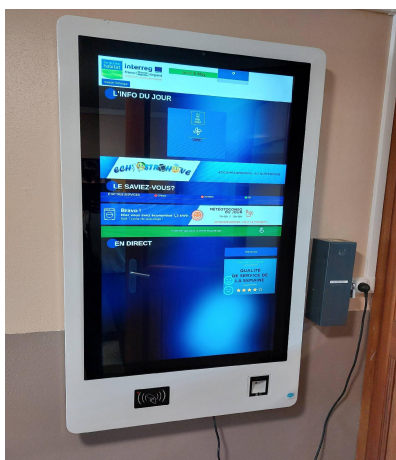
Images 18 et 19. Totem installé à l'entrée de la résidence Maréchal Leclerc pour suivre la consommation et production électrique de l'opération ACC - Source Photographies personnelles
