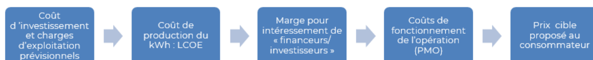
Figure 70 : Détermination indicative du prix livré au consommateur d'une AAC en modèle « équilibré » - Source : Cohérence Energies
