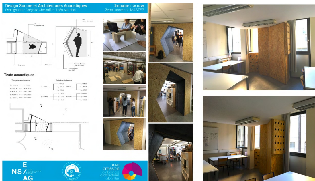
Exemples de dispositifs construits et testés dans le cadre de notre module optionnel de design sonore avec Théo Marchal à l'ENSAG (2019-2020). Image de gauche : seuil entre deux pièces de bureaux (expérience de mouvement impliquée : passer à travers), images de droite, traitement d'une salle de classe à proximité d'une fenêtre (expérience de mouvement impliquée : se pencher au-dehors).
