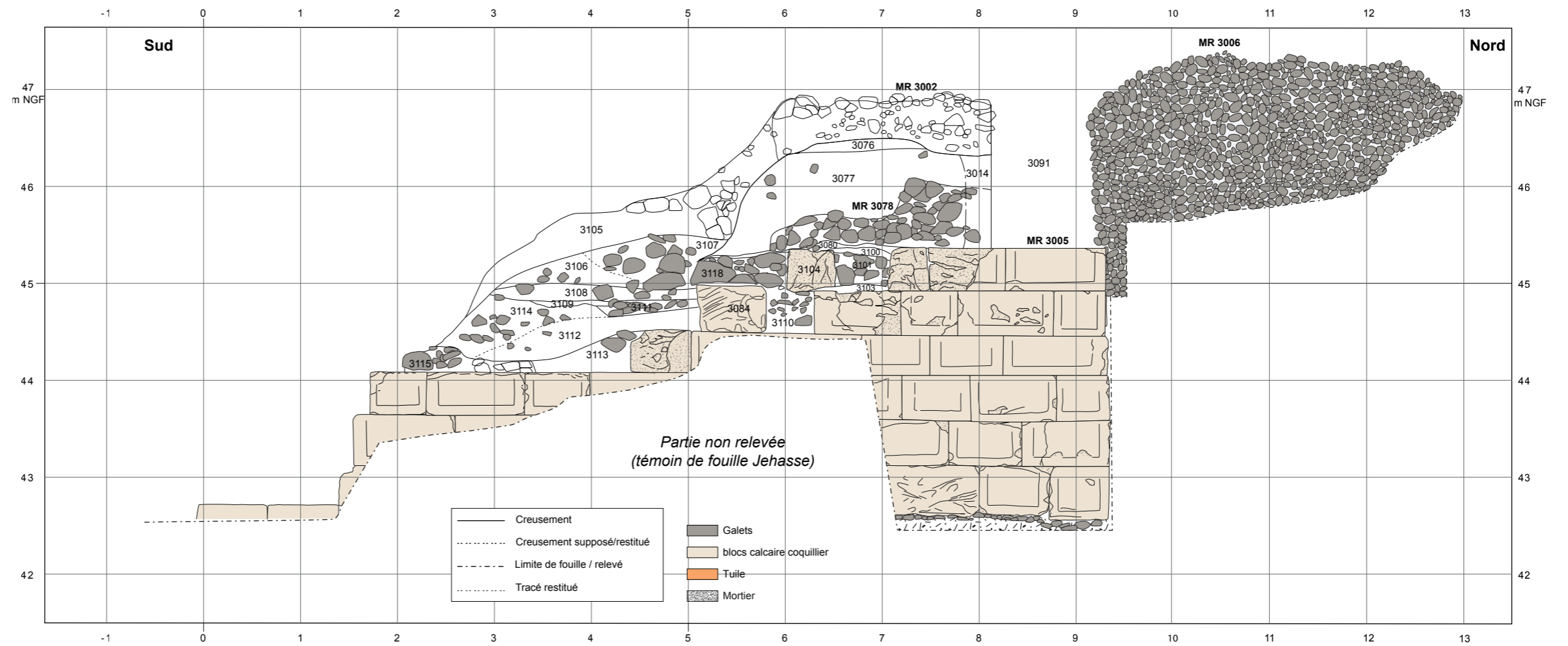
Fig. 6 : La coupe 3S06 (parement oriental de la tour T0U3090) (S. Sanz-Laliberté / E. Gailledrat / P. Fontaine).
