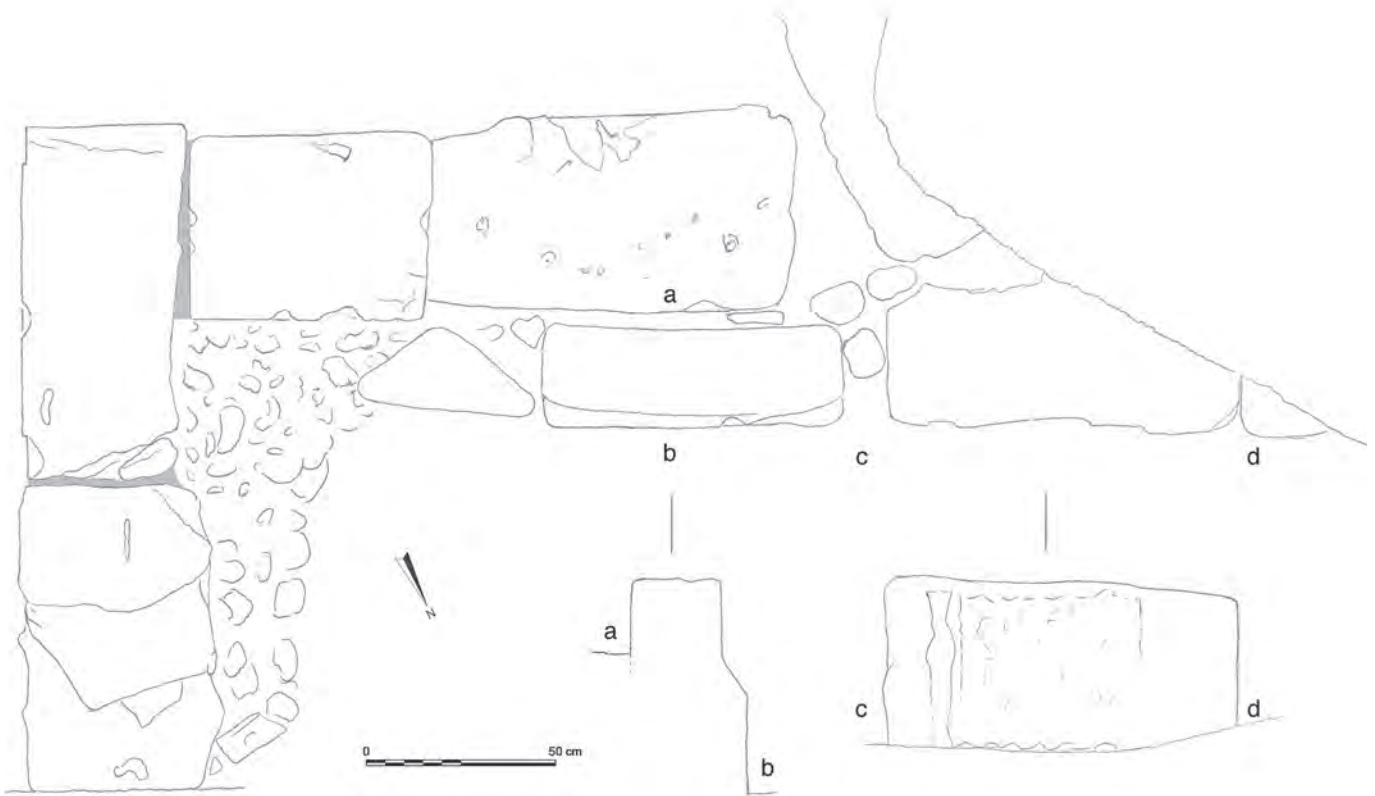
Fig. 16 : Courtine RMP2074, MR2122 - 2073 - MR2074. Plan d'ensemble et détail des blocs 2073a (coupe a-b) et 2073b (face nord c-d). Relevés au 1:20e (dessin P. Fontaine)
