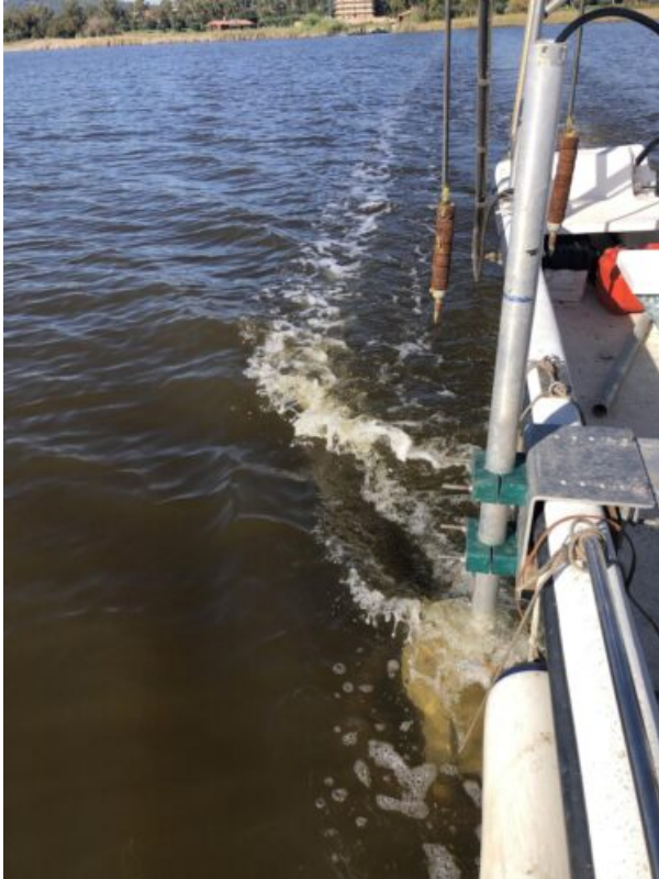
Fig. 4. Photo montrant l'installation des transducteurs (émetteurs-récepteurs) sur perche métallique verticale contre la barque dans la lagune de Burano. Cliché JP Goiran.
