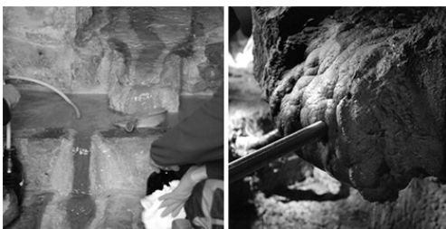
Figure 1. Deux lieux de prélèvement de concrétions calcaires : le regard Saint-Martin, appartenant au réseau des sources du Nord, et le regard XIII de l'aqueduc de Rungis
