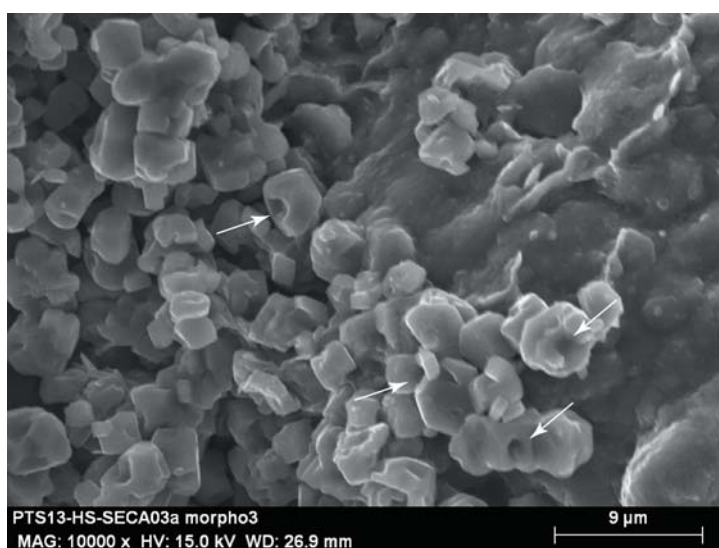
Figure 14.15 : Micrographie MEB en SE de la matière colorante couvrant S-ECA-03. Phyllosilicates en plaquettes hexagonales de 3 à 5 \mu\text{m} avec golfes de dissolution (flèches blanches).
