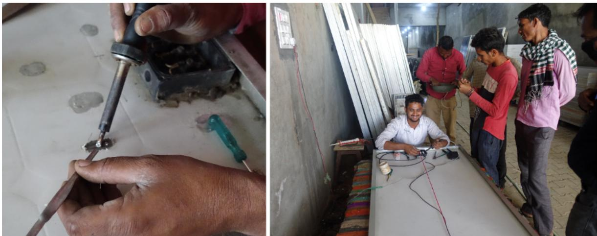
24. Modification de panneaux solaires d'occasion. Adaptés pour charger une simple batterie 12V (commune et répandue), ces panneaux solaires vivent une seconde vie dans les zones rurales de l'Inde, où ils sont plébiscités par les ménages en situation de pauvreté énergétique. Uttar Pradesh, Inde (Rémi de Bercegol, 2022)
