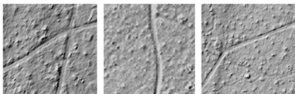
11– Exemples de structures linéaires en creux dérivés de l'ombrage du MNT (avec une exagération verticale de 4), issus des données LiDAR-HD [© E. Vautier 2024]
