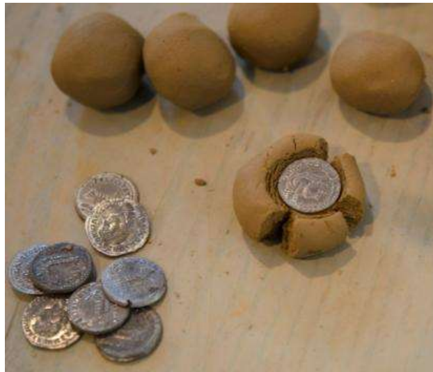
Figure 233, protocole de façonnage d'après Barakat 2005 (gauche), tentative réalisée avec la terre du Clos-Paul (à droite).
