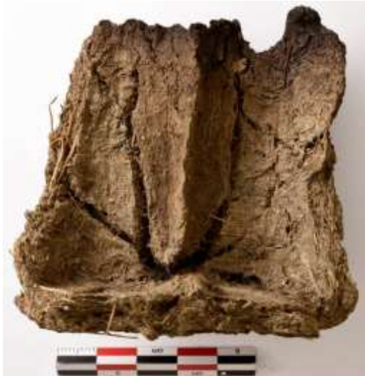
Figure 240, fractures visibles sur un fragment de couche évent après séchage.
