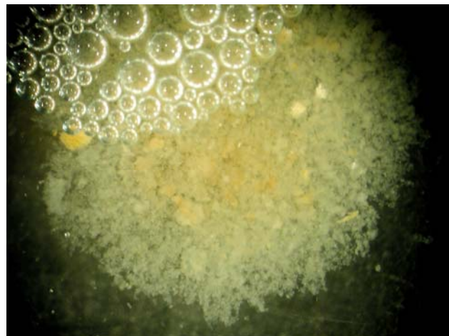
Abb. 1498.Probe 08.2: HCl- Auszug der Probe; das Bindemittel entspricht Probe 6.
