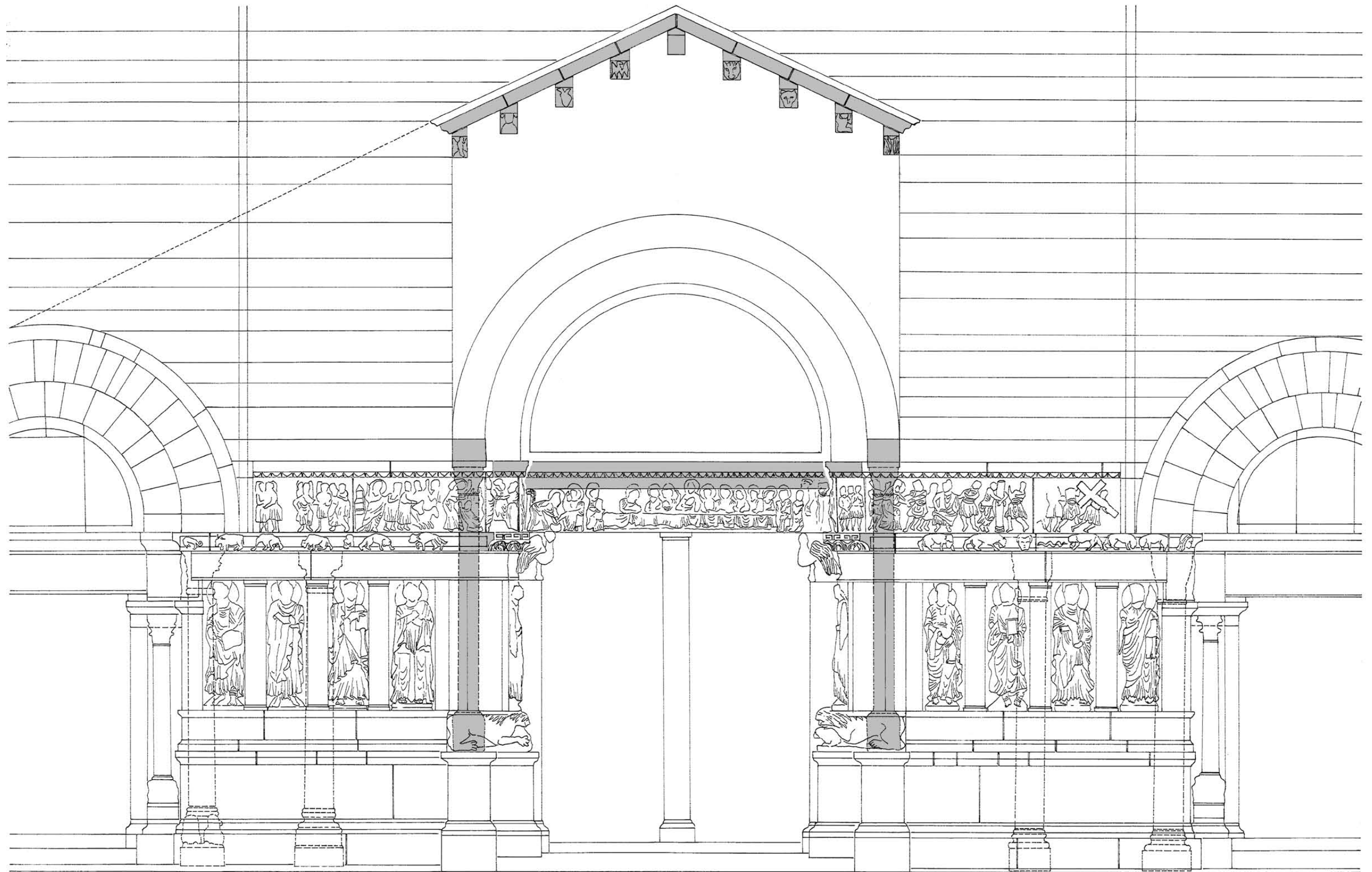
Tafel 53 Rekonstruktion eines Protiros im Hauptportal (Grau angelegte Flächen nach Baubefund, Höhe des Giebels angenommen)
