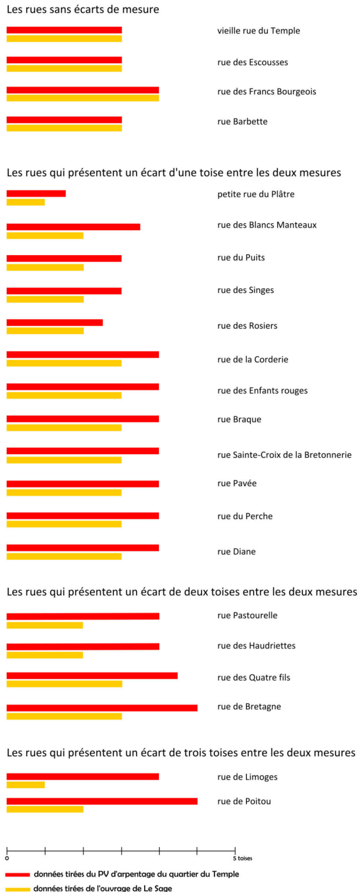
Figure 79. Représentation graphique des écarts de mesure de largeurs constatés à la confrontation des données tirées du procès-verbal d'arpentage du quartier du Temple et des données tirées de l'ouvrage de Le Sage
