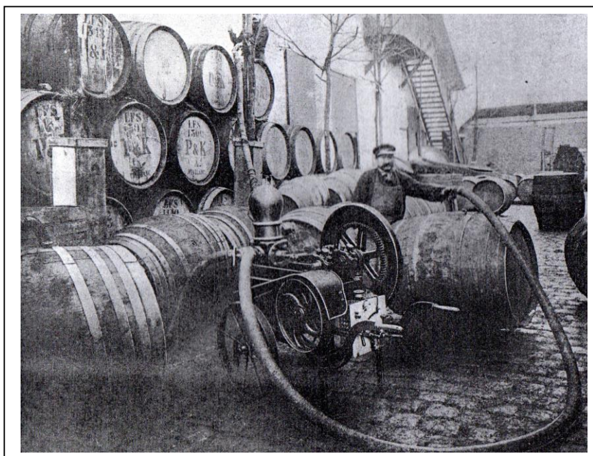
Fig. 15 : Pompe électrique baladeuse à Sète Début des années 1920 – « Parlier & Krüger » Source : SIGURET E., op. cit. , p. 43
