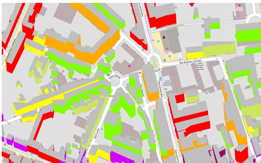
Figure 65: Cartographie en pseudo 3D de la valeur maximale de bruit pour une journée calculée en façade d'un bâtiment.
