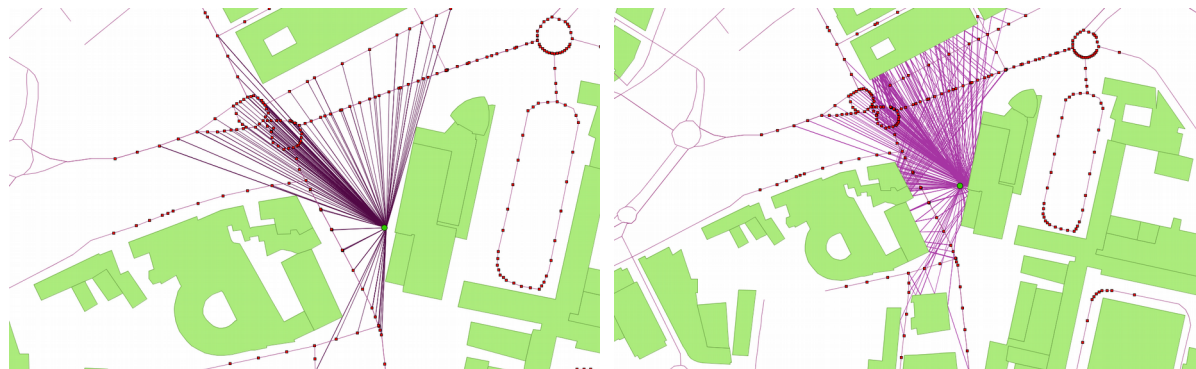
Figure 63: Calcul de la propagation acoustique : à gauche en champ direct à droite en champ réfléchi d'ordre 1 (Fortin et al., 2012a)
