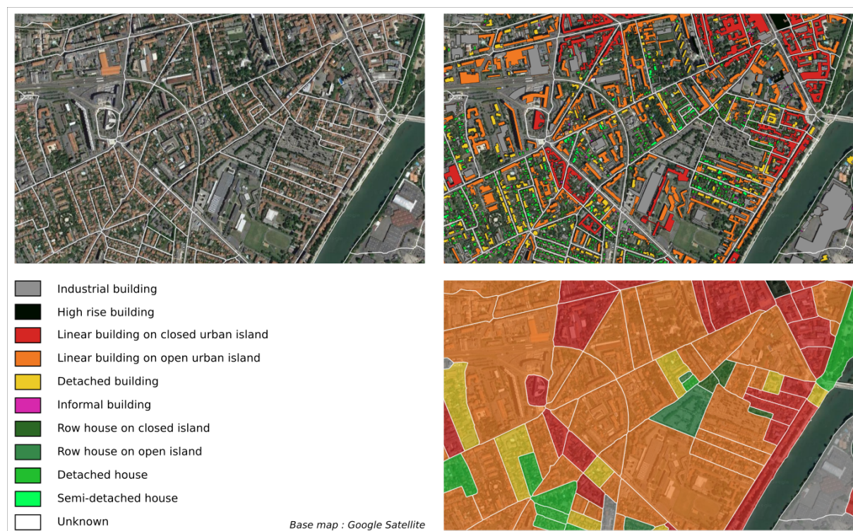
Figure 55: Extrait de la classification du tissu urbain obtenu par apprentissage sur Toulouse (Bocher et al., 2018)
